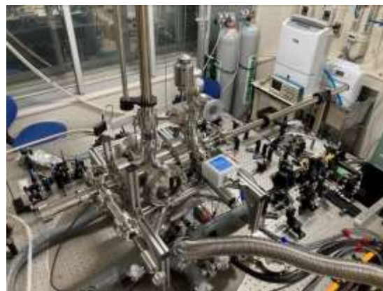
図 1: 構築した極限環境 THz-STM の外観
