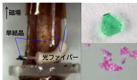
図：FBG 磁歪測定 の試料環境 (左)。 [(\text{CH}_3)_2(\text{NH}_2)]_3[\text{Cu}_3(\text{OH})(\text{SO}_4)_4] \cdot 0.24\text{H}_2\text{O} (右上) [(\text{CH}_3)_2(\text{NH}_2)_3(\text{SO}_4)]_2[\text{Co}_2(\text{COO})_3] (右下) の単結晶の写真。
