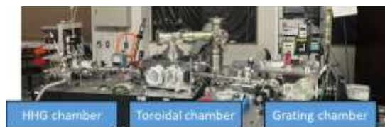
図 2: 実験室において建設した HHG ビームライン。
