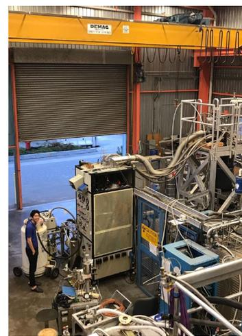
希釈冷凍機を用いた  $\mu$  SR 測定の検出器部分
